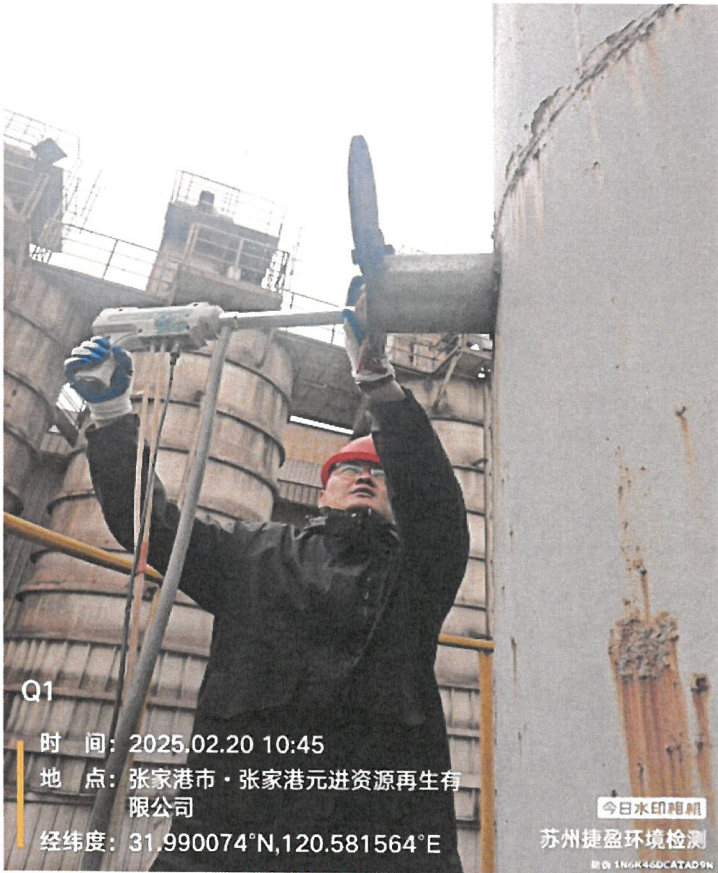
采样点位: 排气筒 1#出口 Q1
